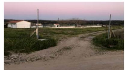
RETRANQUEAR LA ENTRADA ACTUAL MEDIANTE LA INSTALACIÓN DE PUERTA DE DOS HOJAS. DELIMITACIÓN MEDIANTE CERCADO DE MALLA SIMPLE TORSIÓN DE 2 m
